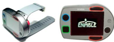
Bild 1 Prototyp mit integrierter Sturzerkennung (ENABLE, 2010)
